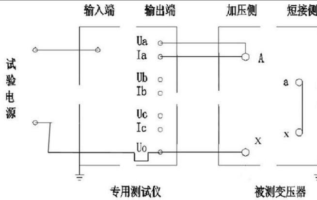
2、变压器三相负载的测量 图十四
