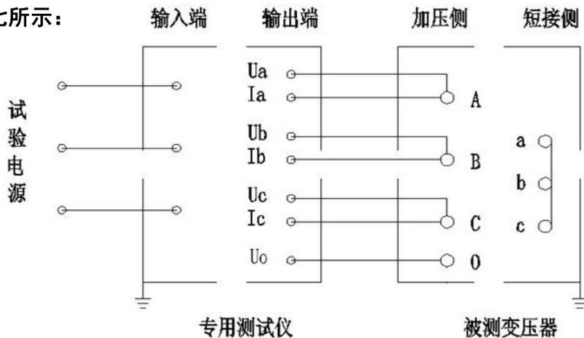
图十七 变压器三相负载测试接线图
