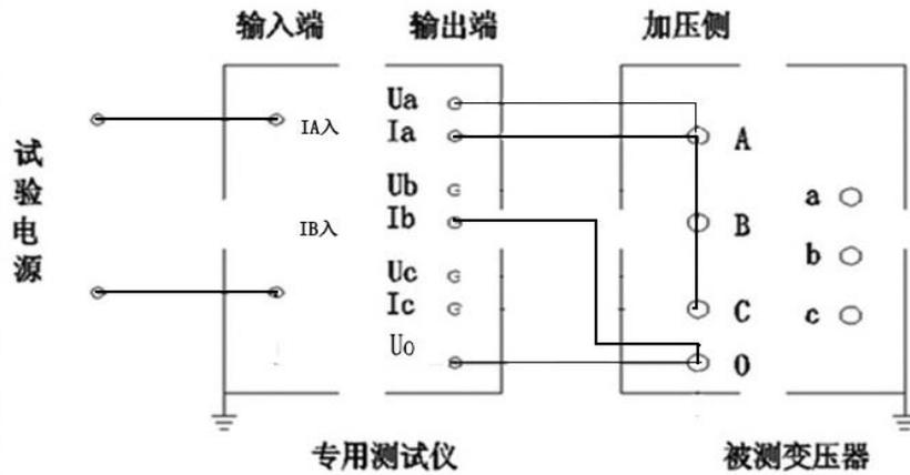
图二十九 零序阻抗接线图
