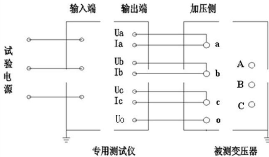
图二十 变压器三相空载测试接线图
