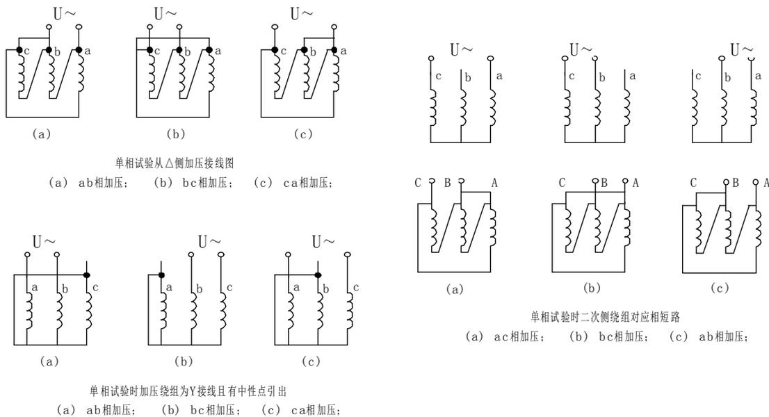
**附录三：单相电源负载损耗试验接线图**
