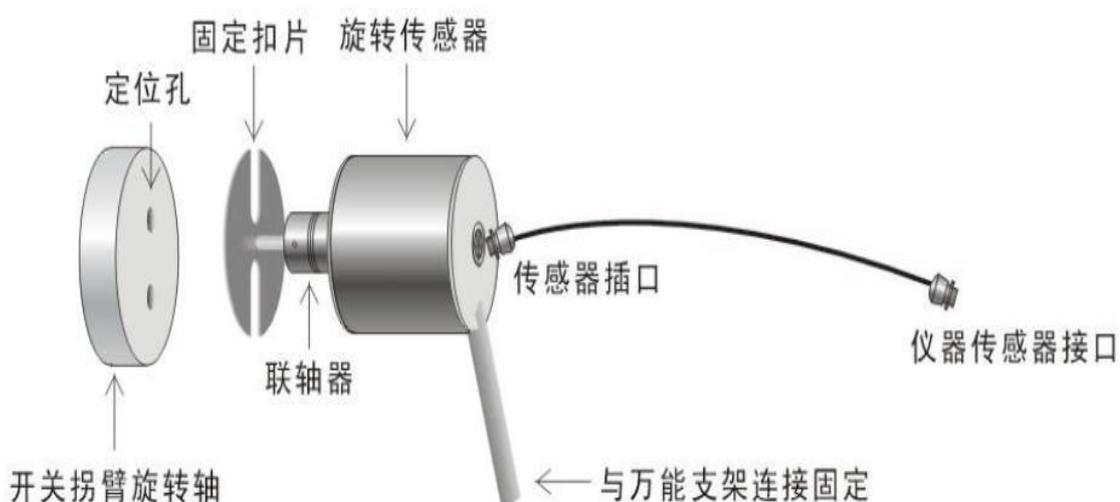
**安装注意：**旋转传感器的轴应尽量与开关旋转轴保持同心，否则传感器旋转有阻碍，测出曲线的毛刺会很重，影响测试数据的准确。
