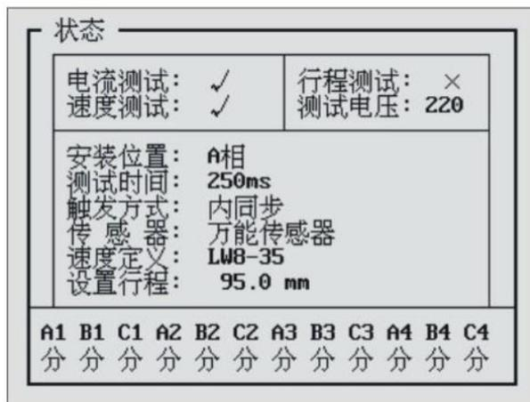
在这个界面下可以检测仪器的断口通道是不是完好，断口输入如果是悬空，应该显示“分”，如果对地短路，则应该显示“合”。所以分别把各个断口对地短接一下，观察状态显示的变化，来确定仪器断口时间通道是否正常。
