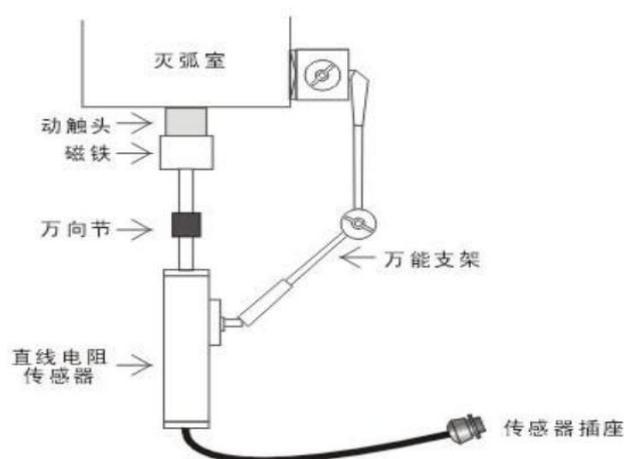
**提示：**直线传感器因其现场安装的烦琐性，针对不同的开关，自己设计安装支架，保持传感器的拉杆与开关动触头的运动平行和同步，可以很精确地测出开关的运动行程及相应的速度。
