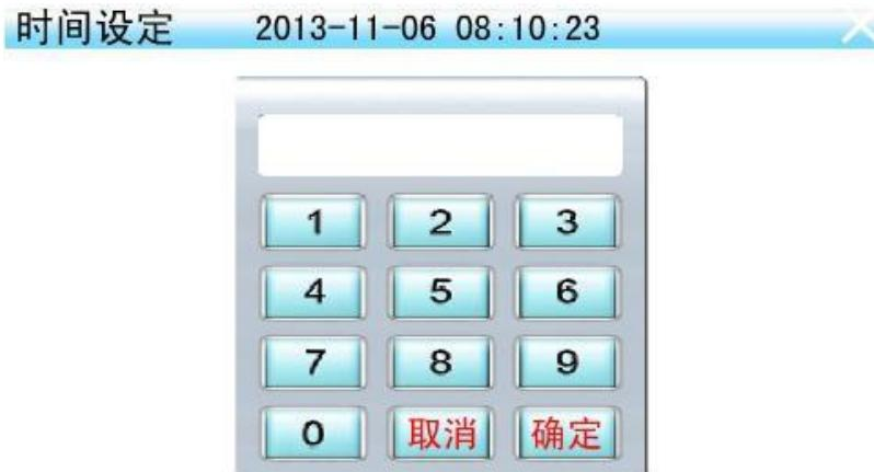
要调整日期、时间时，点击该界面上方的时间显示区域，键盘输入框中即有待修改时间显示(年、月、日、时、分、秒显示区域以“？”代替)，需要按顺序逐个输入，待秒数字输入后，可点击“确定”按钮完成修改。如中途退出，请点击“取消”。
