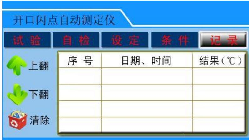
该界面显示已测试样的测定结果试验记录。“上翻”、“下翻”按钮用以翻页查询，“清除”按钮用于清空记录存储区的所有数据记录。当检测类型为“闪点”时，试验结果温度值后面会显示“S”，而当检测类型为“燃点”时，会显示“R”。
