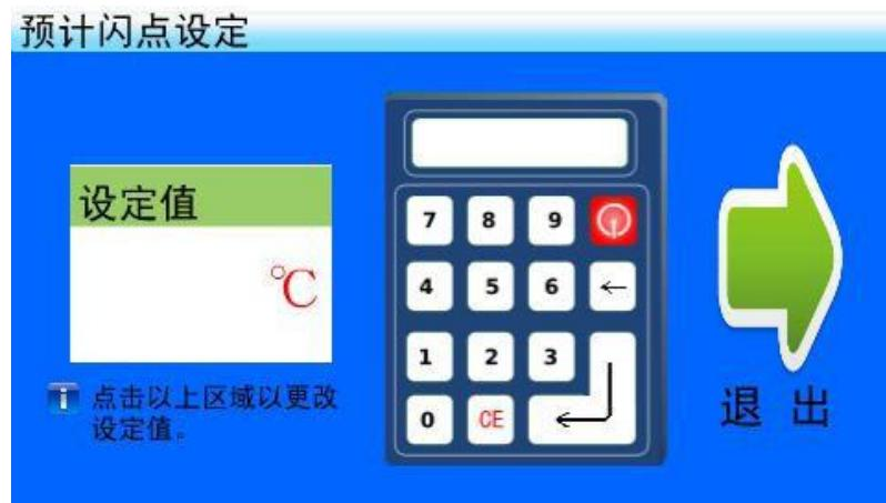
该界面下，点击“设定值”区域，键盘上方预计闪点设定值输入框处光标闪烁，可以输入数字，并按“ $\leftarrow$ ”确认输入。要删除输入的数字，可以点击“ $\leftarrow$ ”。点击界面右侧“退出”图标，退出预计闪点设定界面。
